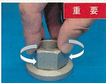
トルクレンチを使って、規定トルクで締め付ける
